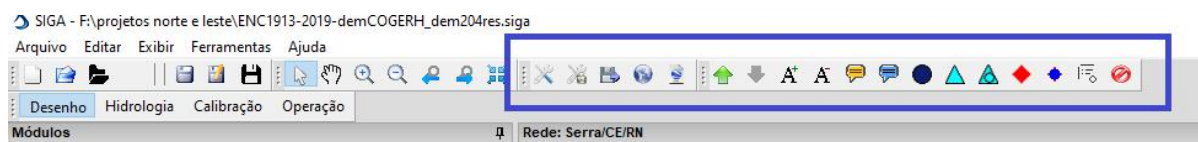
Figura 8.6 - Destaque para as barras de rede e de shape que permitem trabalhar com a rede hídrica no SIGA.
