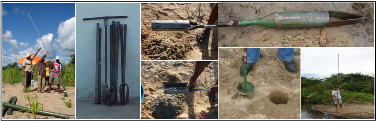
Figura 4.04 – Equipamento utilizados nos serviços de sondagens (hastes, copos, ponteira e tubos de manobra).
