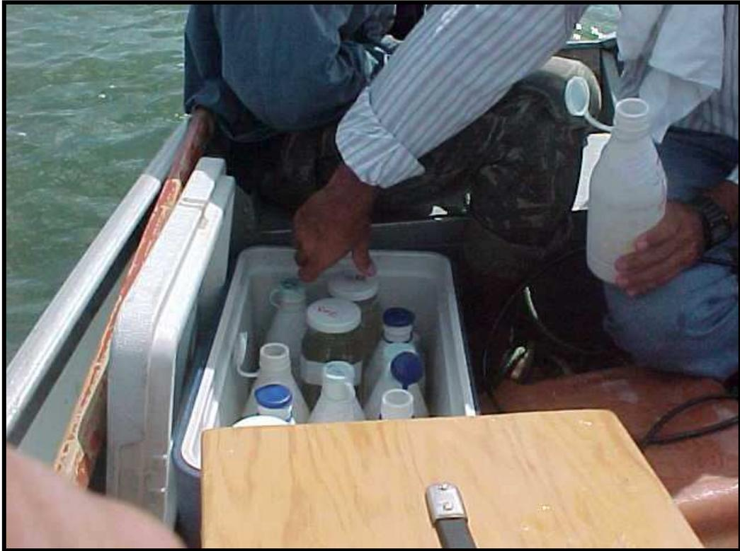
Figura VII.5 – Refrigeração das amostras após a coleta.
