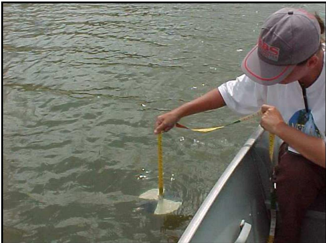
Figura VII.2 - Disco de Secchi, para medida da profundidade de penetração da luminosidade.
