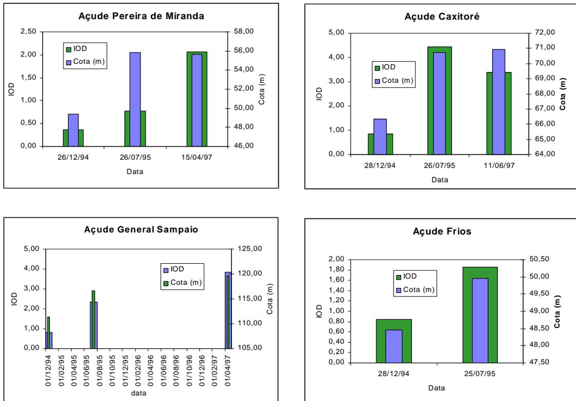
FIGURA 6.2.1 - Comportamento sazonal do IOD e nível dos açudes da bacia do Curu, entre 1994 e 1997
