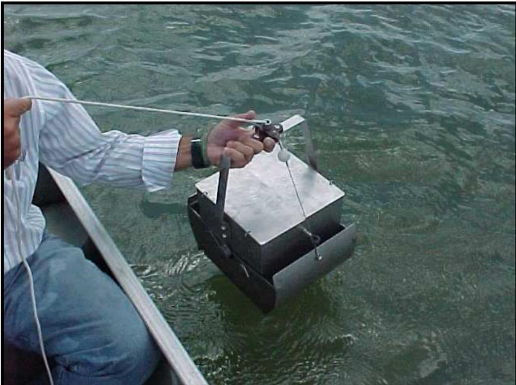
Figura VII.6 – Draga utilizada nas coletas de amostras de sedimento de fundo.
