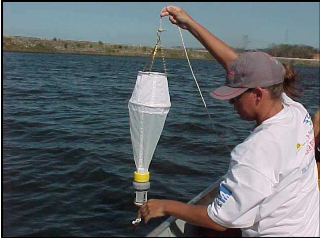
Figura VII.7 – Rede coletora empregada na coleta de amostras para identificação das comunidades planctônicas (Estudos de eutrofização).
