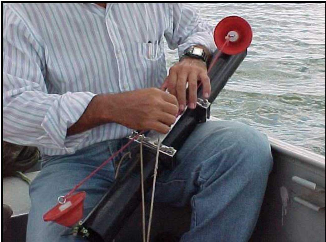
Figura VII.4 – Coletor de amostras de água tipo Van Dorn, utilizado para coleta de amostras de água ao longo da coluna d'água.
