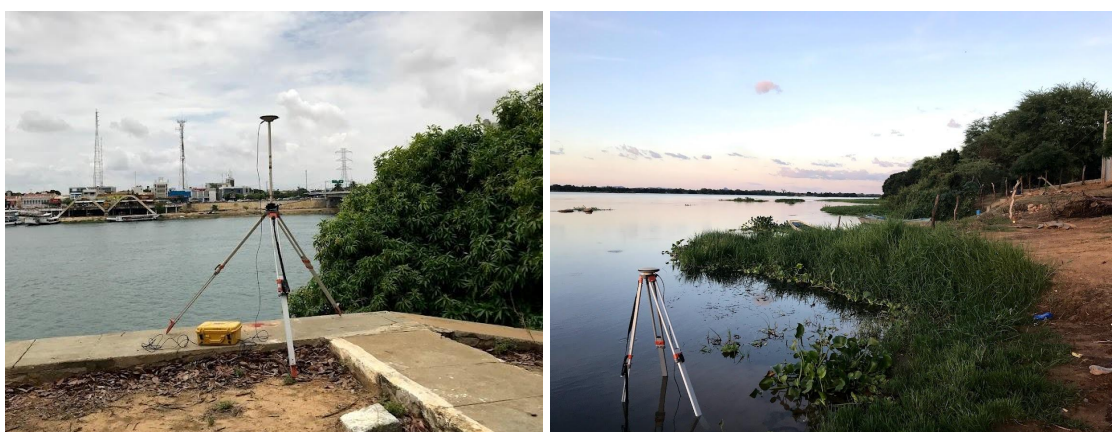
Figura 4. Trabalhos de campo para nivelamento absoluto do nível dos reservatórios. Fonte: Autor, 2022.
